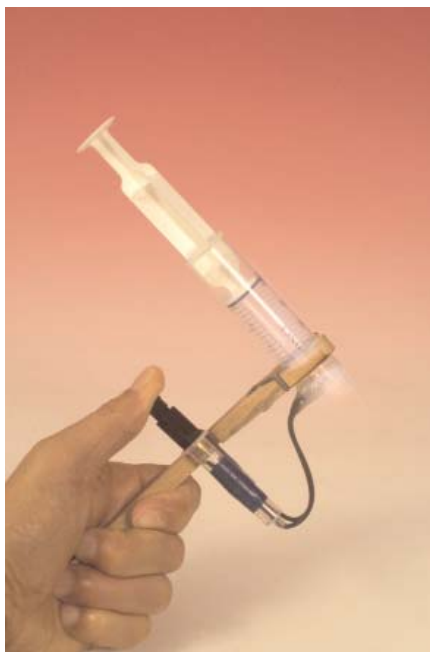
Abb.6: 6 mL CH 4 gemischt mit 12 mL O 2 werden in der Low-Cost-Kanone piezoelektrisch gezündet. Der Stempel muss freie Flugbahn haben, sonst ist er kaputt.
