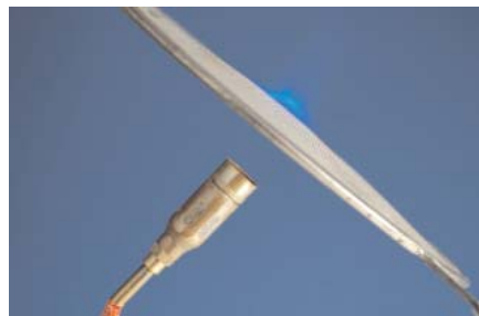
Abb. 3: Modellversuch zur Davyschen Sicherheits-Grubenlampe mit Lötlötl (Baumarkt) und einem Fettspritzschutzgitter (Haushaltsware).
