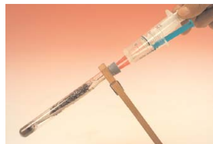
Abb. 4: LC-Gasentwickler mit geringem Totvolumen für Methan aus Al-Carbid: Ein Tropfen Siliconöl bremst das Schäumen, der Wasserdampf wird durch die Scheuerspirale zurückgehalten.
