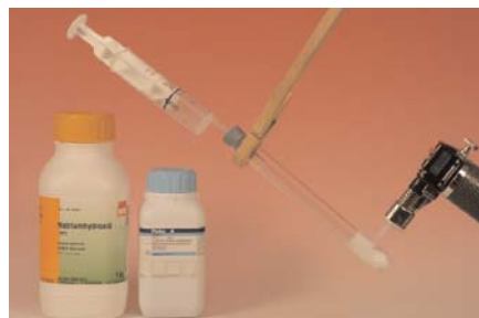
Abb. 5. LC-Gasentwickler mit geringem Totvolumen für die bevorzugte Herstellung von Methan aus Na-Acetat und Natriumhydroxid. Durch dosiertes Erhitzen lässt sich die Gasentwicklung gut steuern.
