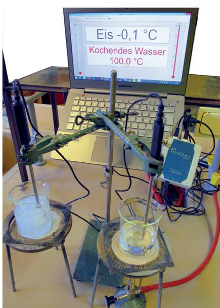
Abb. 3: Versuchsanordnung zur Schmelz- und Siedepunktsbestimmung
