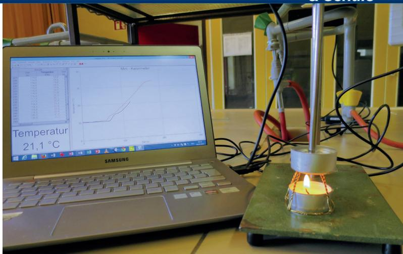
Abb. 7: Versuchsanordnung zur Heizwertbestimmung
