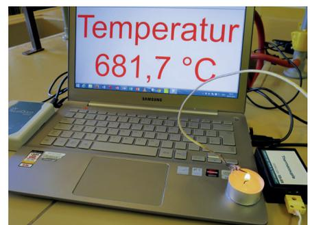
Abb. 4: Versuchsanordnung zur Messung der Flammentemperatur eines Teelichts
