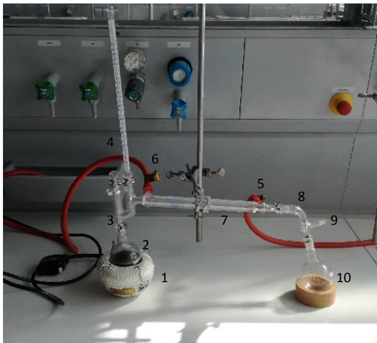
Abbildung 14: Aufbau der Destillationsapparatur
